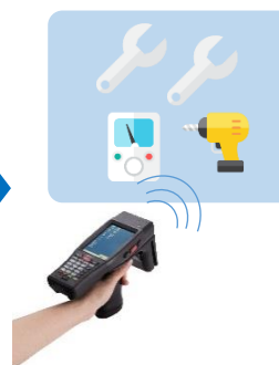
④ ICタグを読み取り ハンディーターミナルで 持ち出す工具のICタグを 読み取ります。
